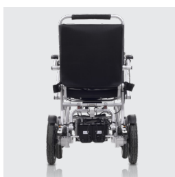
2 baterías de 10Ah
